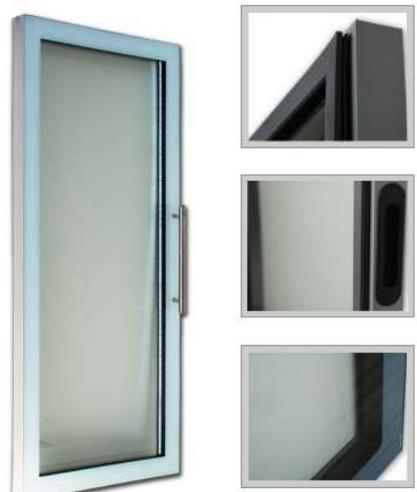
Porta composta da telaio in alluminio verniciato assemblato su vetro camera, la guarnizione interna con la sua forma personalizzata garantisce l'isolazione tra interno frigo ed esterno porta.
