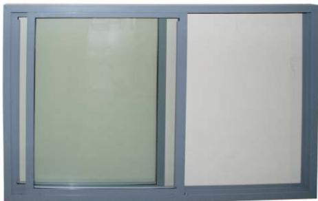
Sistema scorrevole composto da telaio e anta in PVC con alloggio di vetro camera da 20mm; la barra maniglia garantisce la massima presa su tutta l'altezza dell'anta mobile; possibilità di installare ABS e sistema di autochiusura delle ante con blocco.
